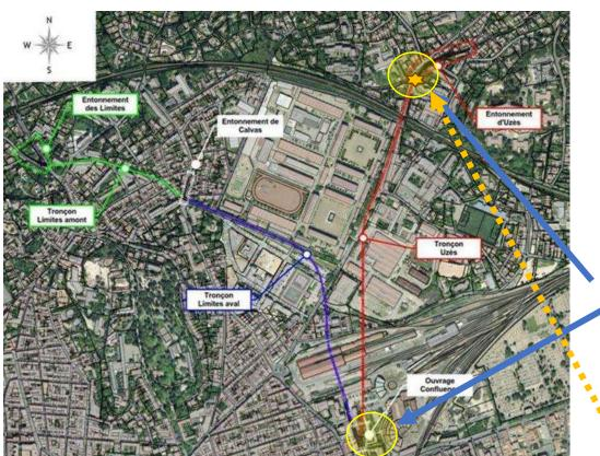
Travaux en cours 2023-2026 : Tronçons des cadereau d'Uzès et Limites aval en tunnelier (Ø 3,3 m)
